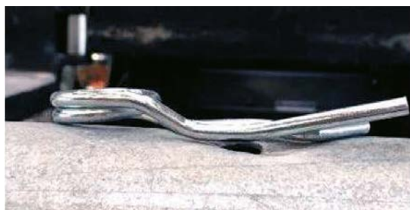
5,0 mm efter 400 kg dynamisk belastning
