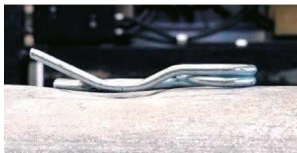
3,5 mm efter 400 kg dynamisk belastning
