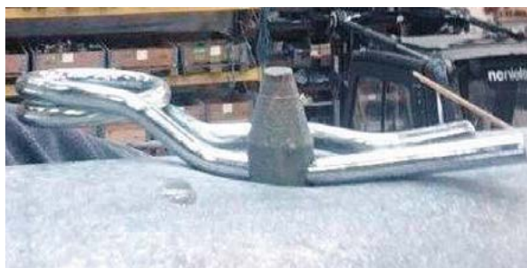
5,0 mm efter 400 kg dynamisk belastning
