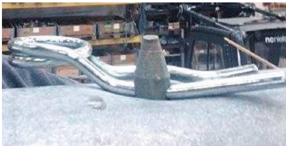
5,0 mm efter 400 kg dynamisk belastning
