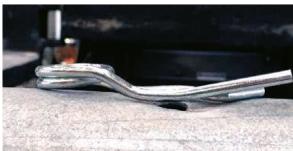
5,0 mm efter 400 kg dynamisk belastning
