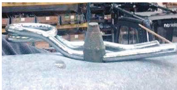
5,0 mm efter 400 kg dynamisk belastning
