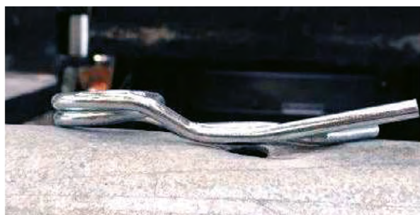
5,0 mm efter 400 kg dynamisk belastning
